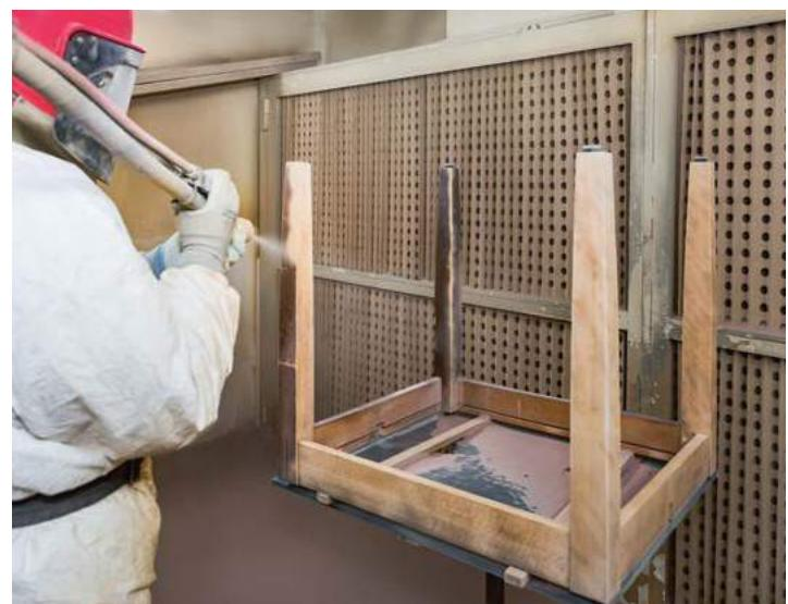
Sandstrahlarbeiten in einer speziellen Kabine / Sablage dans une cabine spéciale
