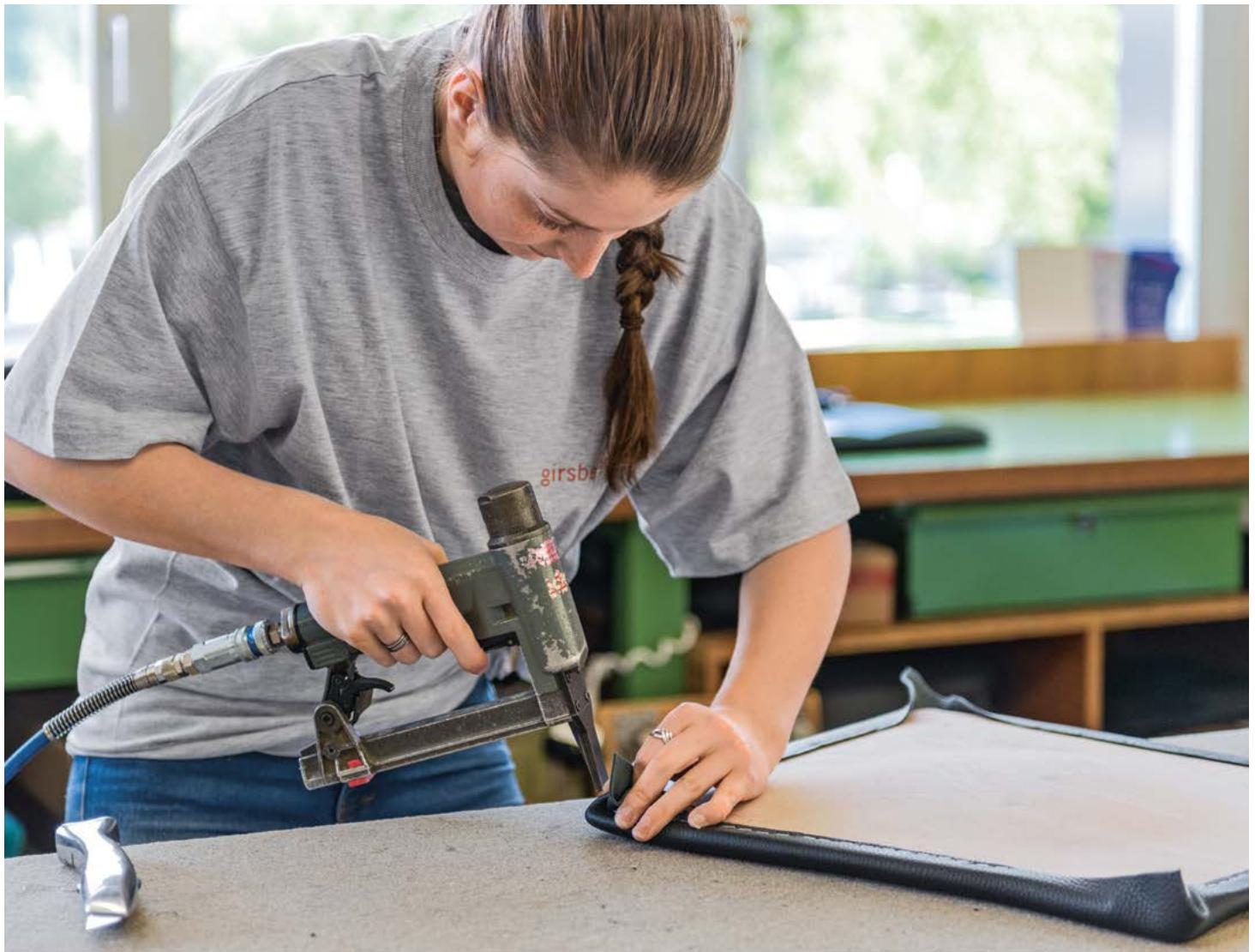
Ein Sitzbrett wird in Handarbeit mit hochwertigem Echtleder neu gepolstert. / Une plaque d'assise est équipée à la main d'un nouveau rembourrage recouvert de cuir.
