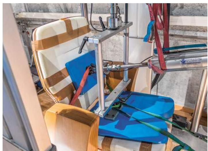
Belastungstest der neuen Klappbeschläge / Tests des nouvelles charnières
