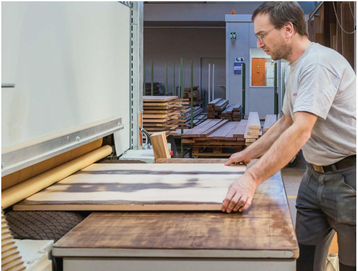
Das Abschleifen der Tischplatten erfolgt maschinell. / Le ponçage des plateaux de tables est réalisé à la machine.
