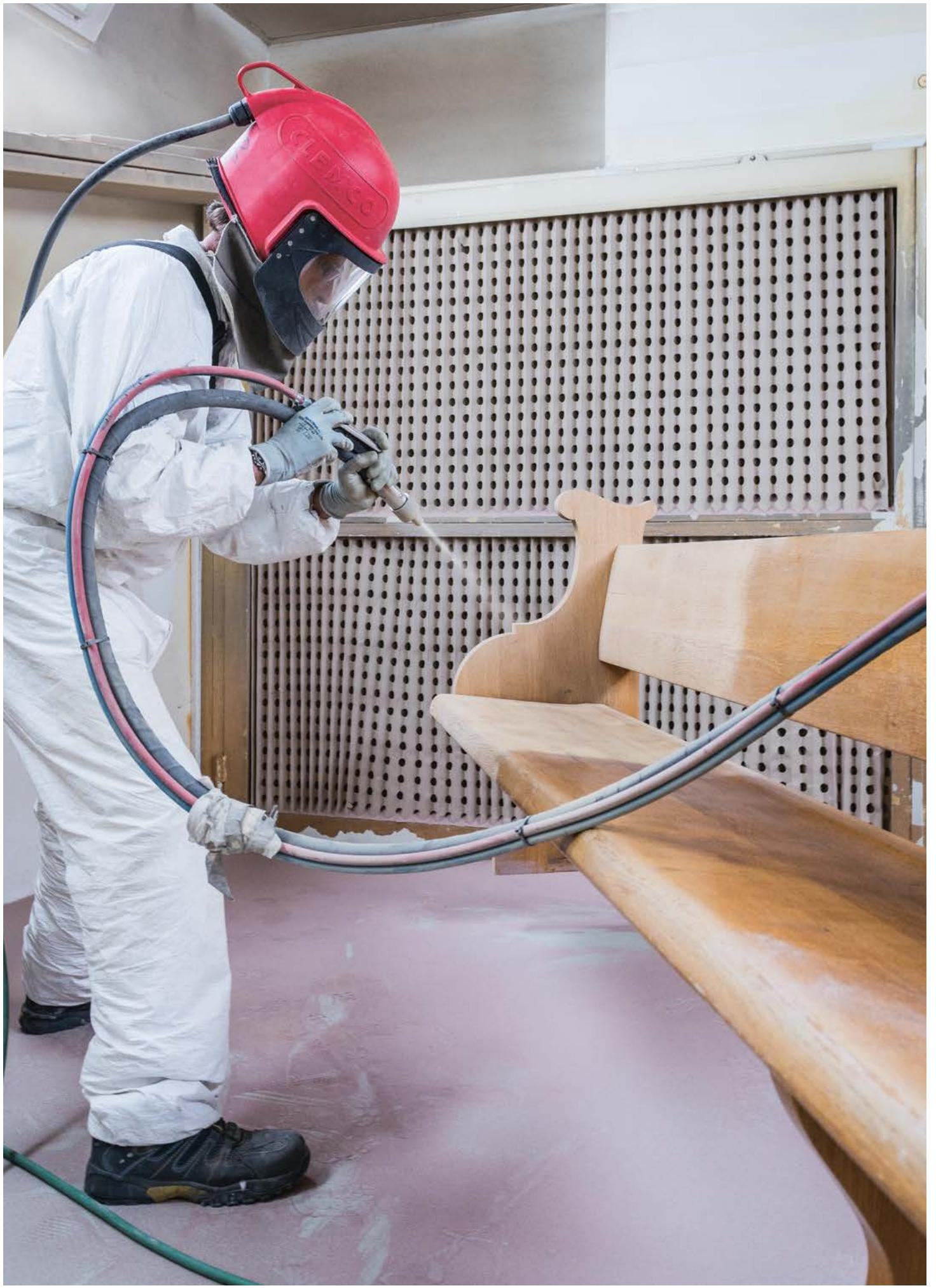
Die beschädigte Lackschicht wird mit Quarzsand schnell und gleichmäßig abgetragen. / Le vernis endommagé est rapidement et uniformément retiré avec du sable.
