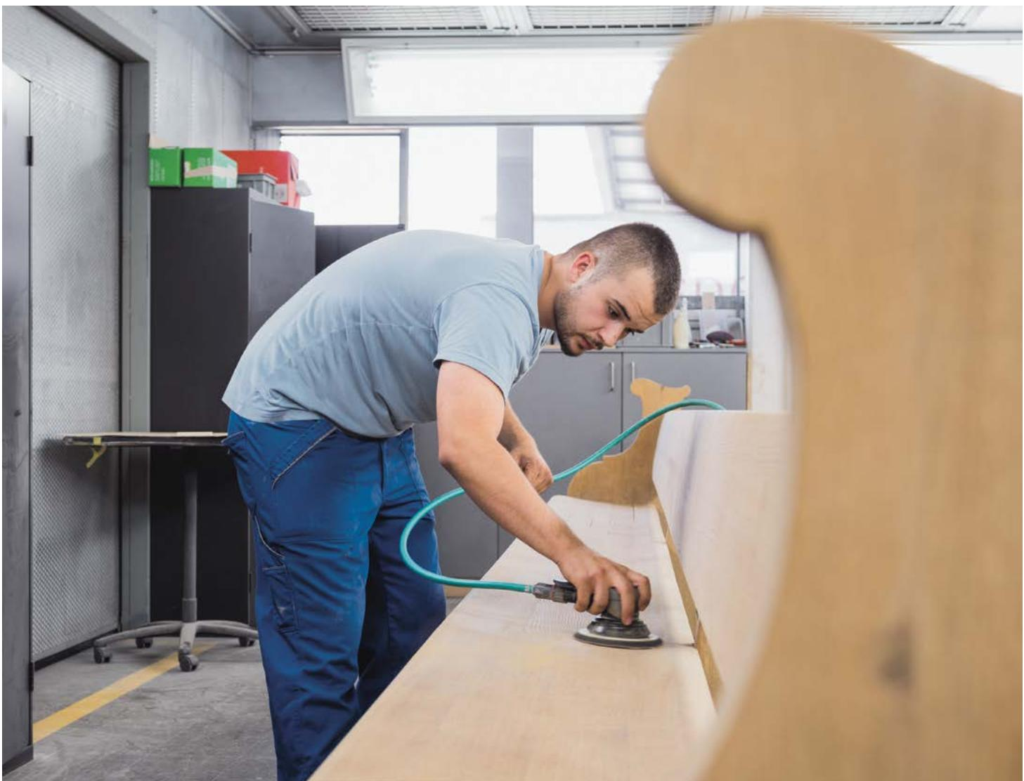
Nach dem Sandstrahlen erfolgt der Feinschliff der Sitzfläche. / Après le sablage, la surface d'assise a été finement poncée.
