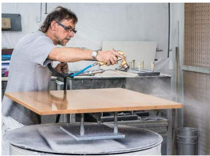
Auftragen der transparenten Lackierung / Application d'une laque transparente
