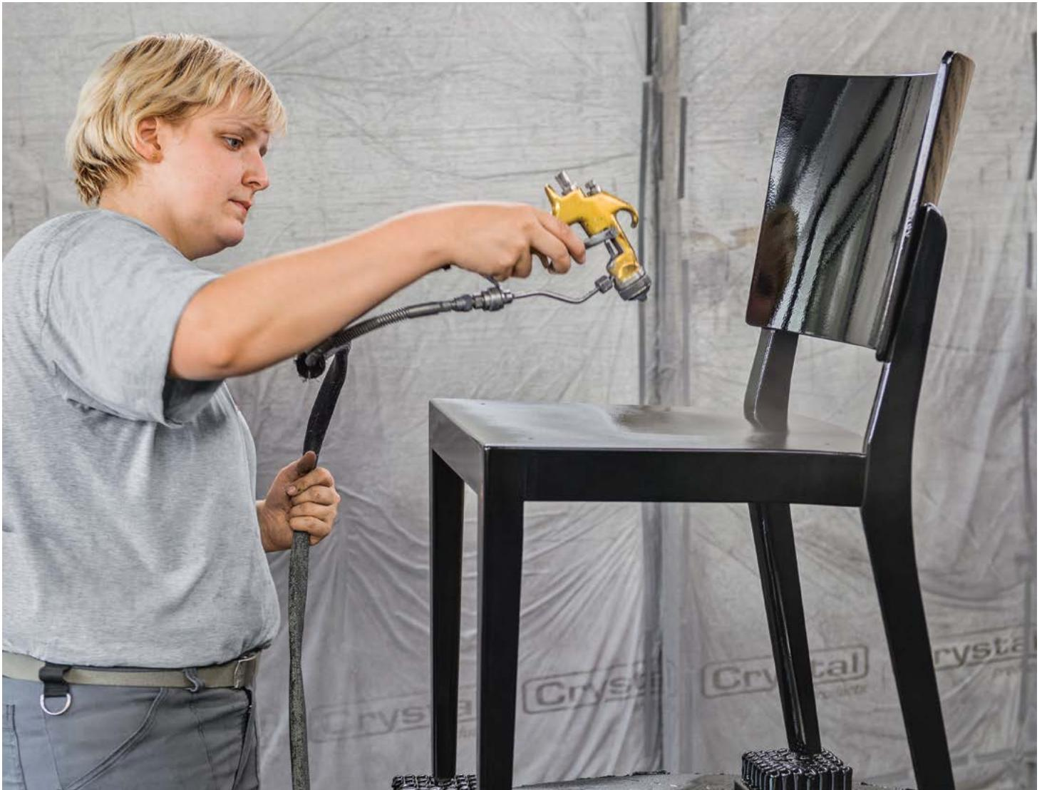
Lackiert wird in der Überdruckkabine, damit keine Staubpartikel auf die Farbfläche gelangen. / Le laquage est effectué dans une cabine pressurisée.
