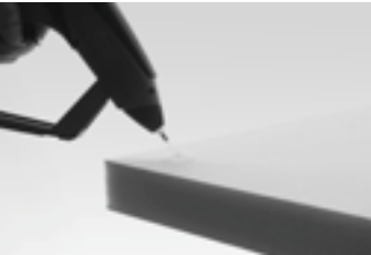
Montage mit Heiß- und Montagekleber
